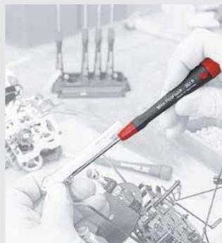
Für eine besonders lange Lebensdauer werden die Klinsen aus bestem, hochwertigem Chrom-Vanadium-Molybdän Stahl hergestellt. Anschließend in einem kontrollierten Prozess durchgehend gehärtet und mit einer matten Chromschicht versehen. Die passgenaue ChromTop®-Klingenspitze sorgt für einen sicheren Sitz im Schraubenkopf.
