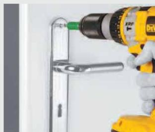
Der Diamant-Torsions-Bit von Wiha punktet gleich 2-fach: er verringert die Anpresskraft und erhöht die Standzeit.
