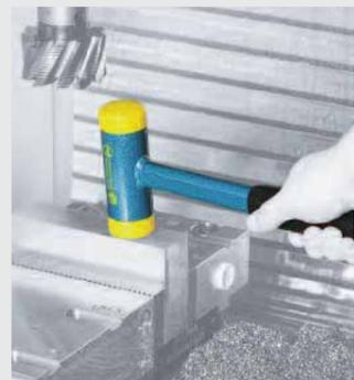
Der Schlagkopf aus mittelhartem Polyurethan sorgt für sattes Aufschlagen und schont dadurch empfindliche Flächen und Kanten.
