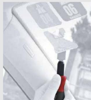
Mühelos lassen sich Dichtungsreste mit dem Wiha Universalschaber entfernen.
