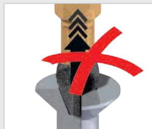
Die Dura-Beschichtung reduziert CamOut-Kräfte auf ein unschlagbares Minimum - kein Herausrutschen des Bits aus dem Schraubenkopf mehr!
