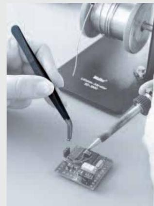
Pinzetten sind wichtige Werkzeuge für jeden Elektroniker, um in den oft kleinen und engen Strukturen der Leiterplatten die erforderlichen Arbeiten sicher ausführen zu können.
