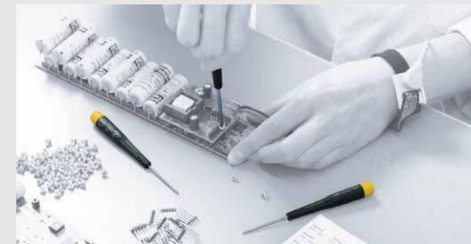
Die ESD-Schraubendreher von Wiha entsprechen den international festgelegten ESD-Normen IEC 61340-5-1. Der elektrische Oberflächenwiderstand liegt bei  $10^6 - 10^9$  Ohm. Dank der Schnelldrehkappe mit großflächiger Fingerauflage kann bequem und schnell geschraubt werden. Das voluminöse Griffende erlaubt ein kraftvolles Anziehen und Lösen von Schrauben.
