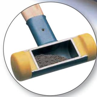
Das Problem der Überbeanspruchung von Gelenken, Sehnen und Muskeln beim Arbeiten mit normalen Stahlhämmern hat Wiha grundlegend gelöst. Der rückschlagfreie Schonhammer sorgt mit seiner speziellen Füllung im Hammerkopf für völlig rückschlagfreies Arbeiten. Berufsgruppen die häufig Hämmer verwenden, wie z.B. im Werkzeug- und Maschinenbau, in der Karosserieinstandsetzung oder Blechbearbeitung, schätzen diesen markanten Vorteil dieses Wiha Schonhammers.
